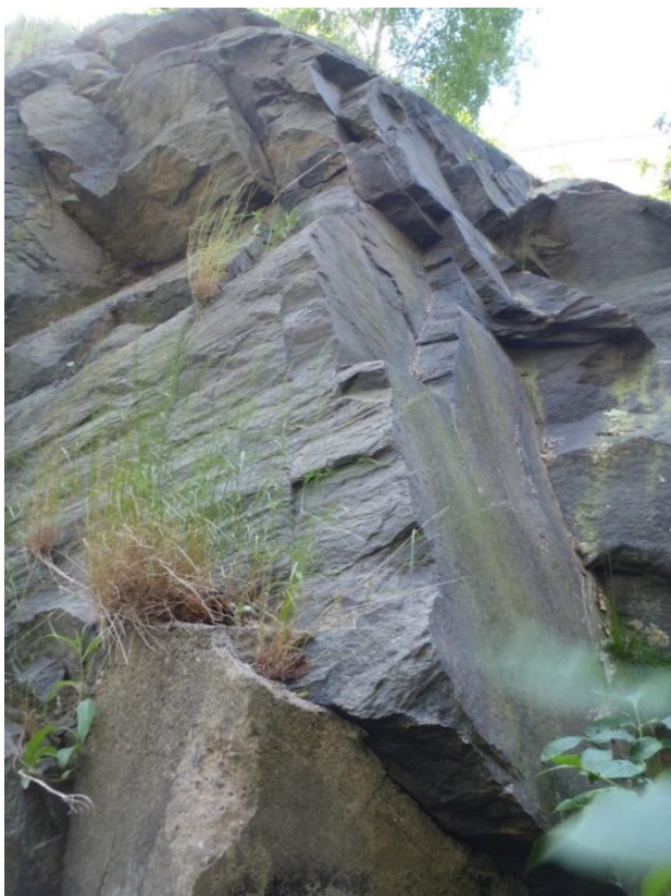
Figur 17: spricksystemen skapar blockighet, dock är dessa sprickor täta och berget har här stöd mot en äldre stödmur.
